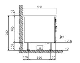
Electrical inlet (power) **Equipotential screw**
